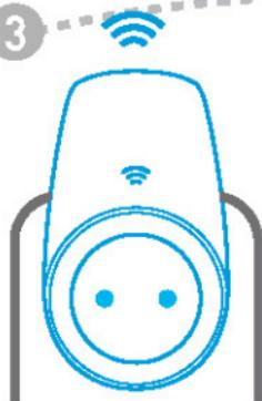
Enchufe NEO Interruptor a una toma de poder; a continuación, pulse el botón ON / OFF durante 5 segundos y suéltelo. El indicador Wi-Fi parpadea rápidamente. Interruptor de NEO está ahora listo para la sincronización.
