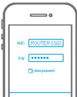
Asegúrese de que su dispositivo inteligente e interruptor NEO están en la misma red Wi-Fi. El proceso de conexión tarda unos 15 a 120 segundos, dependiendo de su estado de la red y la longitud de la contraseña de Wi-Fi.
